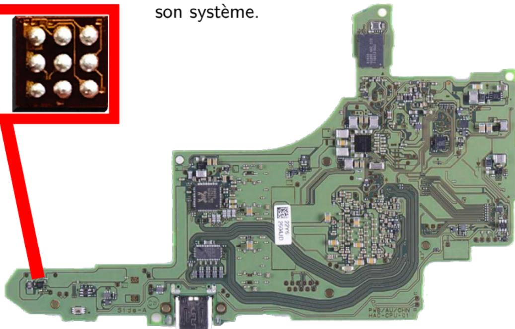
Ce circuit intégré va réaliser des mesures en continu de plusieurs métriques autour de la batterie, puis calculer et prédire plusieurs estimations en son encontre.
