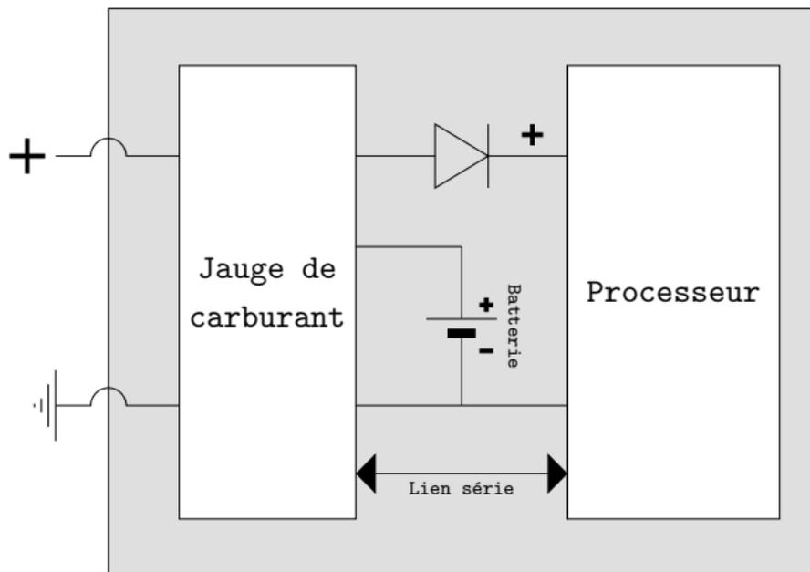
La jauge de carburant s'interpose souvent entre le système central, et les sources d'énergie.
